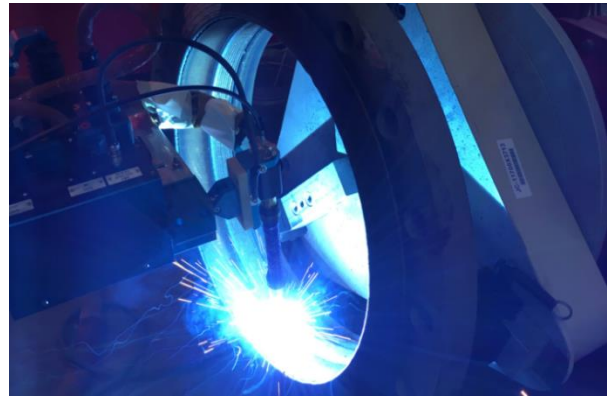
Figura 2: Novos bocais com soldagem de revestimento automatizada
