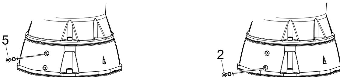
Bild 27 Schmiermittel einfüllen und ablassen PE3 Motor
